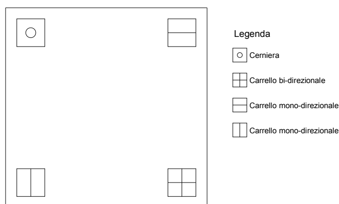
Figura 13 Schema di disposizione dei vincoli nel singolo modulo strutturale
