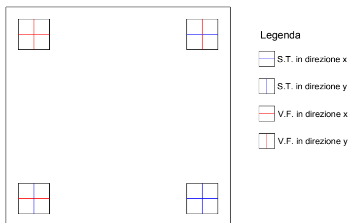
Figura 46 Disposizione shock transmitter (S.T.) e vincoli fissi (V.F.)
